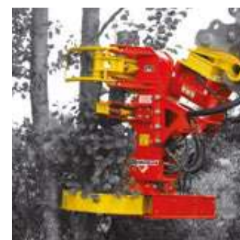
High superior clamps Obere Klemme hält beim Schneiden Zarpas superiore
